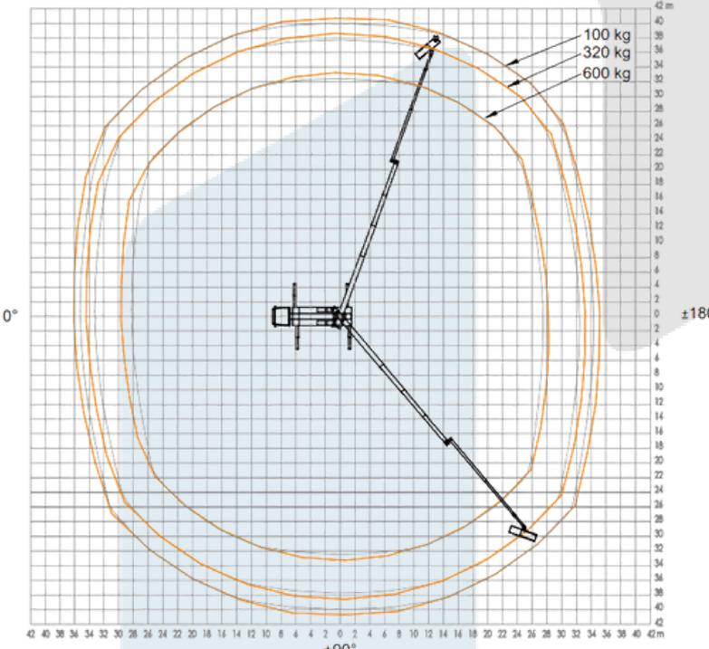
Nacelle équipée du système DRS (Système Dynamique de Déport)
